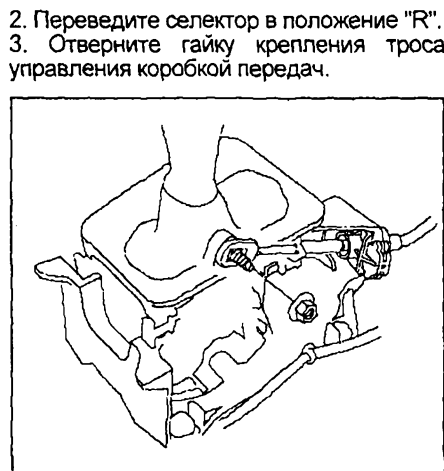
4. Надавите на фиксаторы (А) и снимите держатель (В) троса (С) с кронштейна (D).
