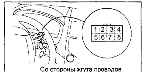
Со стороны жгута проводов
